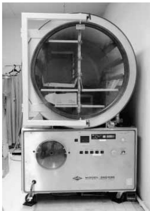
図1 真空凍結乾燥機 36DX66
