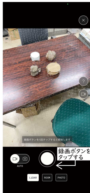
③ Polycamの起動画面。 白格子がスキャン範囲で、録画ボタンをタップして開始する。
