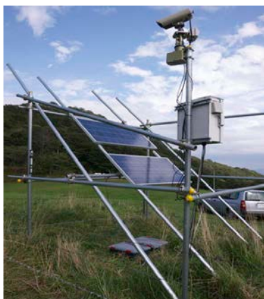
図1 左：太陽光パネル電源で牧草地に設置した 熱画像サーモグラフィ カメラ搭載型のモニタリングシステム、右：受像画面（シカ）
