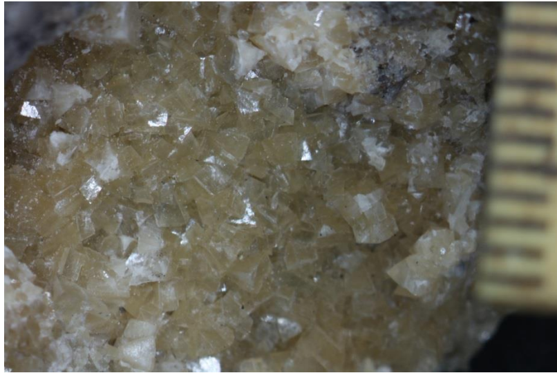
図4 鉍物Bの実態顕微鏡写真 褐色半透明、一部白色不透明、平行六面体の結晶がみられる。
