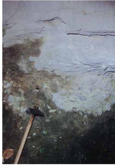
図6 溶結凝灰岩（白色部）と 下位の凝灰角礫岩
