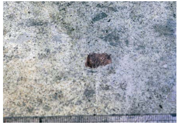
図3-5 反下林道際凝灰岩の研磨面 ものさしの目盛は0.5mm
