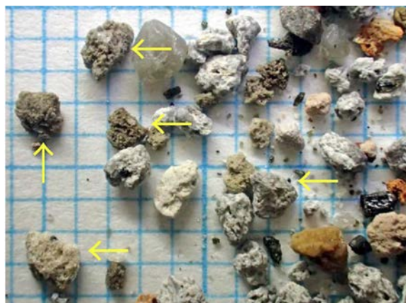
写真9 試料12 (As-B混在) 有色の軽石やpm(sp)型ガラスを含む. As-B粒子を集めて撮影.
