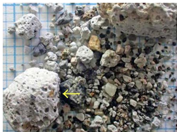
写真6 試料16 変質した明色の岩片が多い.
