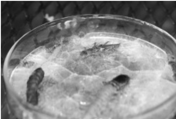
1 真空凍結乾燥機内の資料 減圧下で氷が昇華していく様子
